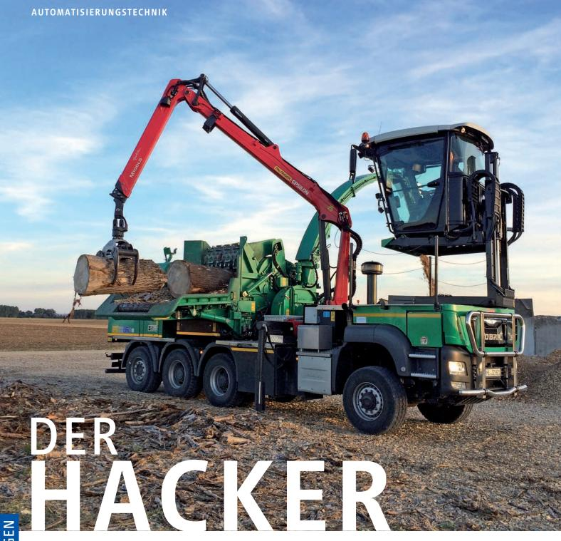
Der HEM 821 macht Kleinholz. Bis zu 80 cm dickes Stammholz hackt er - und das im extremen Dauerbetrieb. Dank leistungsstarker Displays, die perfekt auf den Einsatz in rauen Arbeitsbedingungen zugeschnitten sind, hat der Bediener alles im Blick – und im Griff.
